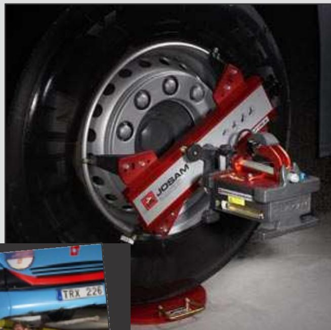
Uređaj za otkrivanje zračnosti (lijevo) upotrebljava se prije mjerena osovine. Univerzalnim uređajem za ispitivanje može se ustanoviti moguća zračnost u ovjesu osovine i kotača
