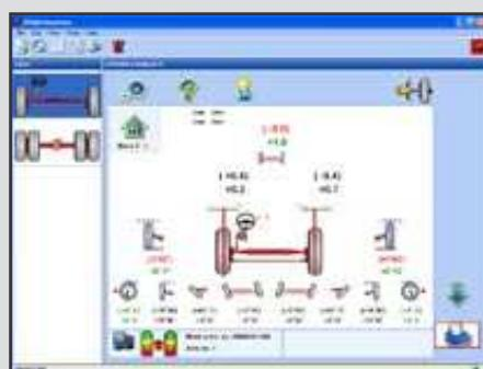
JOSAM homebase s trima tipkama za izravan izbor: „**Brzi start**“ za 4X2 s volanom na desnoj strani. Funkcije trenutačan početak mjerjenja. „**Ispis**“ vode korisnika kroz proces mjerjenja i ispisuje mjerne protokole. „**Novi zahtjev**“ postavljanja obuhvaća podatke o kupcima i vozilima.
